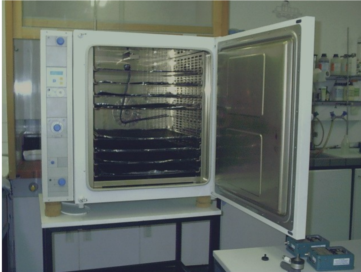
Abb. 1: Wärmetrockschrank mit schichtweise eingelegten Dämpfungsfolien.
